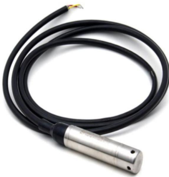
特点编辑稳定性好，精度高投入式液位变送器直接投入到被测介质中，安装使用相当方便。固态结构，无可动部件，高可靠性，使用寿命长从水、油到粘度较大的糊状都可以进行高精度测量，不受被测介质起泡、沉积、电气特性的影响宽范围的温度补偿。投入式液位变送器具有电源反相极性保护及过载限流保护。
